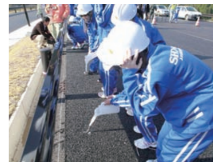
中学生たちが参加した見学会では、排水性舗装の機能を体験してもらいました
